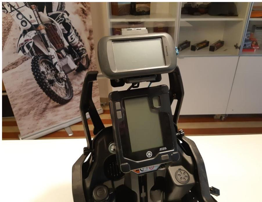
**AC.03.03072.000.001 - TT® - Base di fissaggio per GPS Garmin GPSMAP 276CX-Montana-Zumo XT – RAM / Rugged Phone per barre  $\varnothing$  12 mm.**
